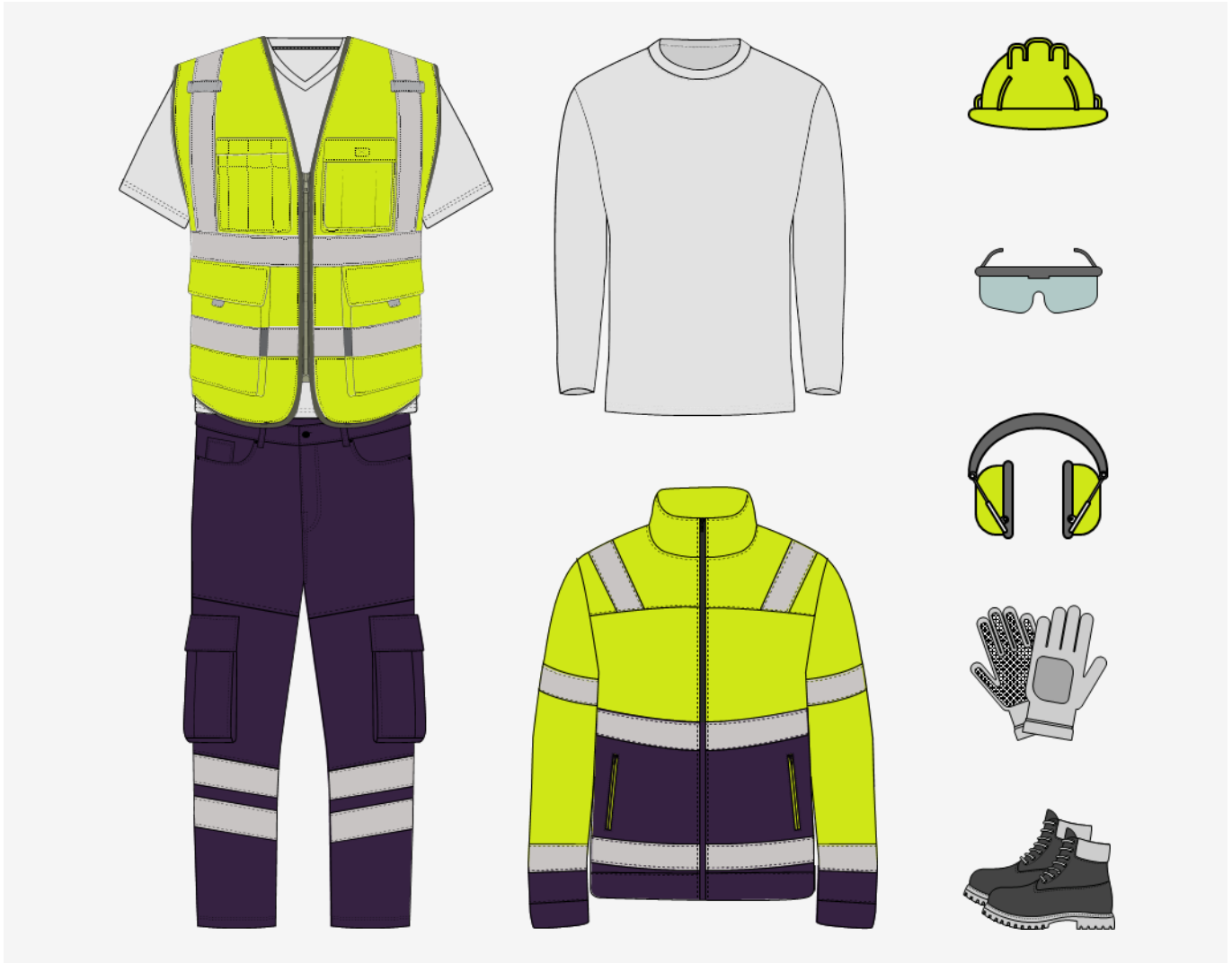
الشكل 1-6-1-2-2: الإصدار القياسي لمعدات الوقاية الشخصية
