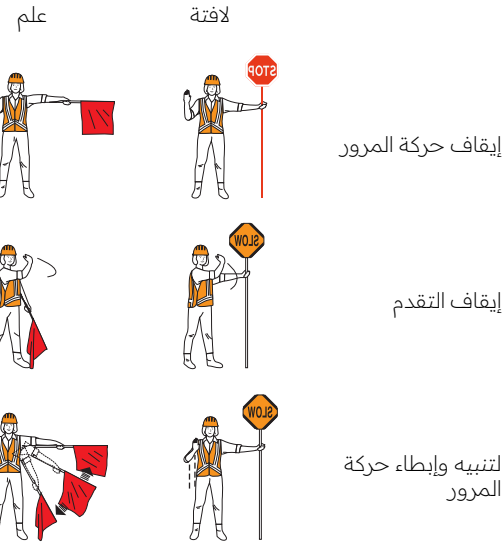
الشكل 1-6-2-2-2: استخدام أجهزة الإشارة اليدوية بواسطة حامل الراية (استنادًا إلى القسم 4-6-7 من كود الطرق السعودي 602 )
